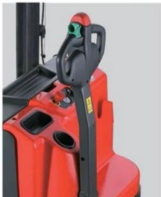
**Diseño Timón largo** para una mayor ergonomía y seguridad. En particular, gracias al diseño de timón largo, el operador siempre puede guardar la distancia necesaria para trabajar de forma segura y ergonómica a la hora de realizar operaciones de apilado. Este Diseño precisa de menores fuerzas operaciones que las máquinas con timón de diseño corto.
