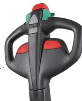
**Elevación y Descenso electrónico y proporcional.** El sistema de elevación proporcional controlado electrónicamente garantiza operaciones precisas de posicionamiento y apilado en cada altura de elevación.
