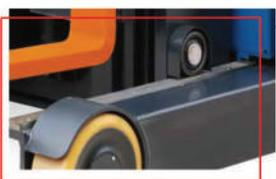
Los riles de deslizamiento hacia delante son de alta precisión y su excelente diseño de compensación de holguras hacen que el mástil sea más estable durante el uso.
