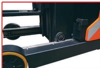
Para reemplazar la batería, la bandeja de protección debes ser desplazada hacia adelante. El mecanismo de liberación de la bandeja de la batería se encuentra cerca del pie del operador.
