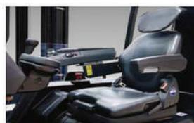
Asiento en suspensión con amortiguación que reduce en gran medida la transmisión de vibraciones al conductor. Al mismo tiempo, la combinación del respaldo curvo biónico de grado automotriz puede reducir eficazmente la fatiga del conductor. El asiento puede ajustarse en múltiples posiciones para diferentes alturas-
