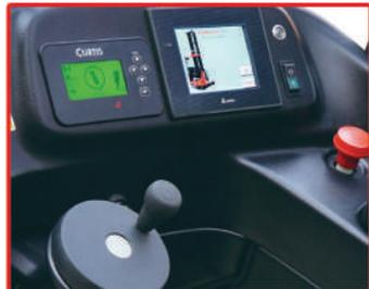
El instrumento LCD multifunción muestra información como la posición del volante, la energía de la batería, el indicador de descarga, el código de error, el tiempo de funcionamiento restante, la velocidad de conducción, etc. Las velocidades de conducción baja, media y alta se pueden ajustar a través del medidor.
