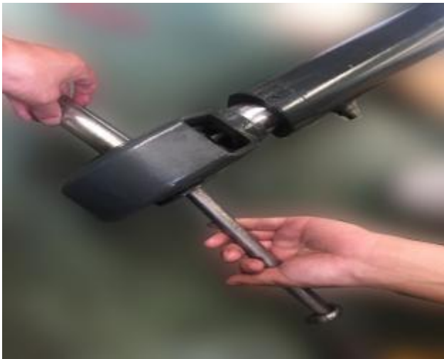
8. Remove sprocket shaft
