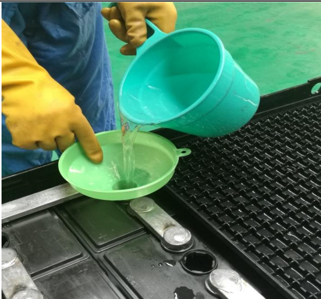
5. Utilice un embudo de plástico para agregar agua.
