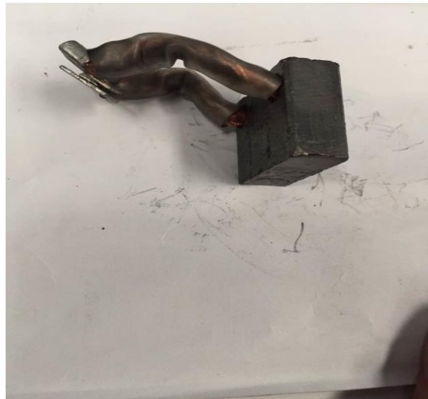
3. Desatornille el tornillo con un destornillador de cruz, saque la escobilla de carbón y reemplácela. Proceso de instalación y proceso inverso del proceso anterior.
