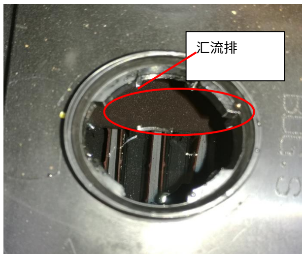
3. La palanca del electrolito está más baja que la barra colectora, luego agregue agua destilada
