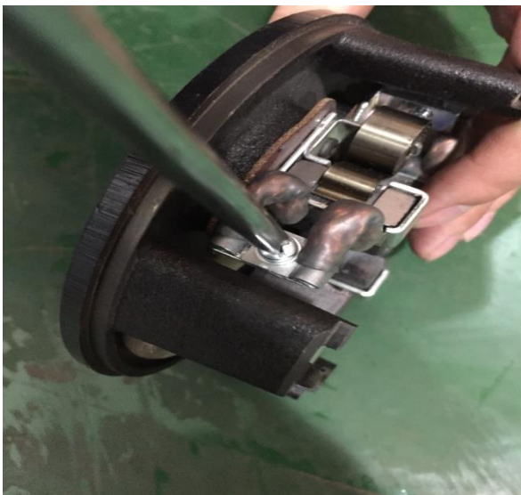
3. Desatornille el tornillo con un destornillador de cruz, saque la escobilla de carbón y reemplácela. Proceso de instalación y proceso inverso del proceso anterior.
