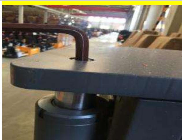
3. Retire el perno fijo en la parte superior del cilindro.
