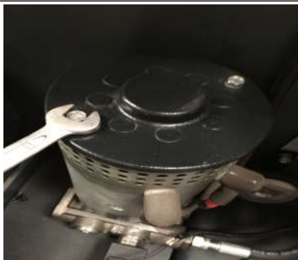
1. Desatornille el perno con una llave abierta de 10 mm.
