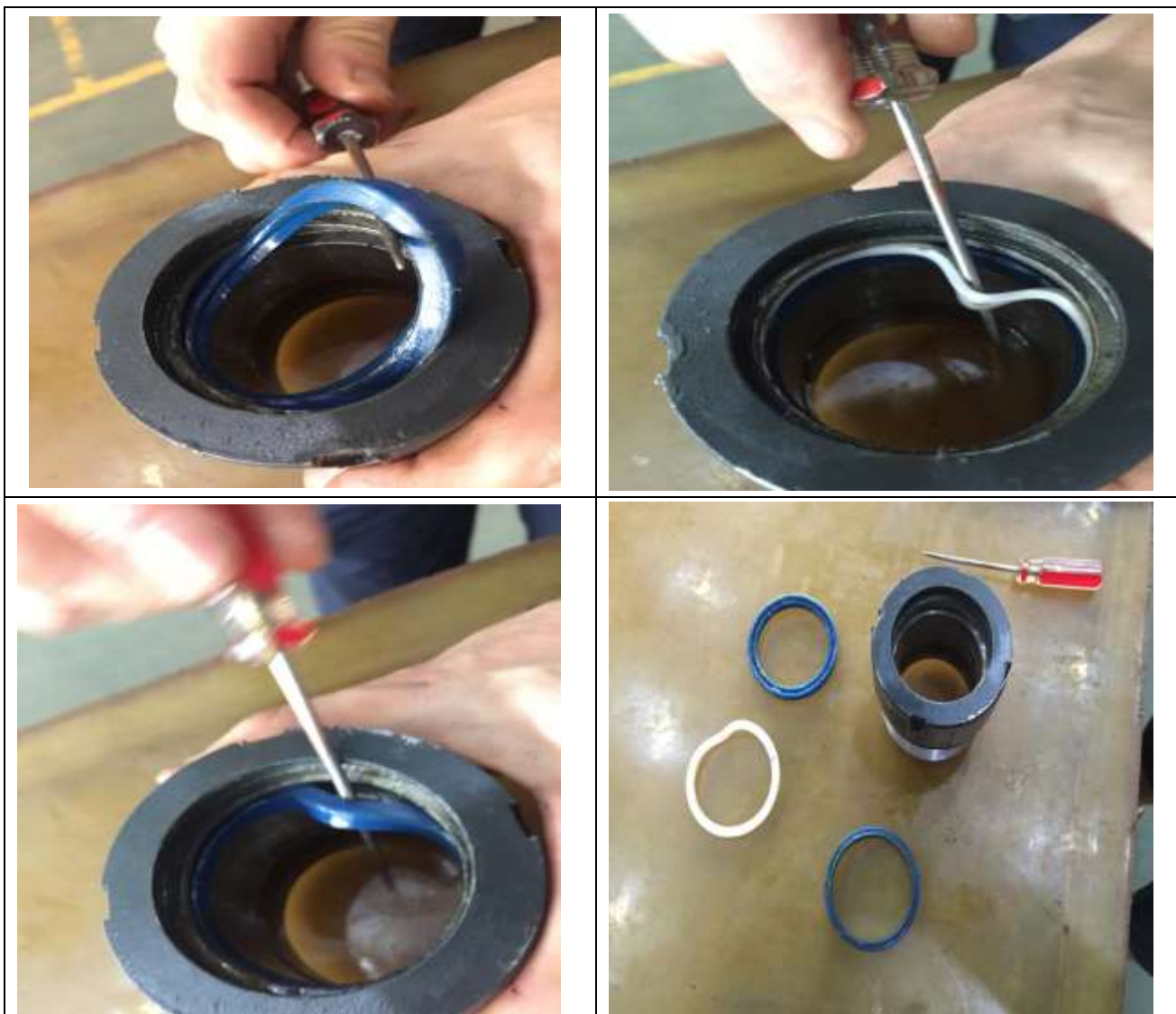
4. Retire el sello a prueba de polvo y el anillo protector y el sello tipo Y
