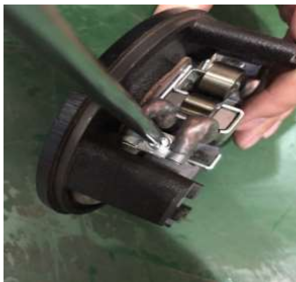
1. Desatornille el perno con una llave abierta de 10 mm.
