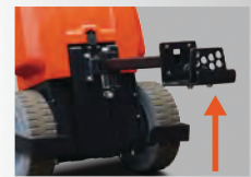
Altura de acoplamiento regulable sin escalonamientos (dirección vertical)
