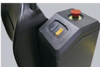
El botón de marcha lenta en ambos lados de la carretilla y el botón de parada de emergencia permiten al operador manejar el tractor hacia delante/atrás mientras camina al lado. No hay necesidad de entrar y salir del tractor. Al mismo tiempo, reduce la velocidad mientras se conduce hacia adelante/hacia atrás haciendo la operación más segura y eficiente.
