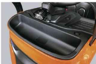
La bandeja de almacenamiento se puede utilizar para almacenar film de plástico y otras herramientas.
