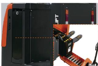
El intercambio de baterías lateral y el soporte de manejo ajustable de manejo hace que la sustitución de la batería sea más fácil y rápida.
