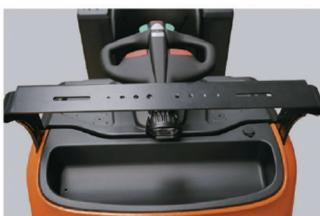
Se puede elegir una variedad de Los acopladores reforzados soportes de expansión para pueden ajustarse a tres alturas cumplir con los requisitos de diferentes para garantizar una instalación de los diferentes conexión fiable con diversos equipos de expansión equipos, remolques, tales como: Pantalla WMS, escáner de código de barras, caja de almacenamiento, carpeta tablero, etc.
