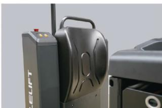
Los flancos de seguridad y los materiales de la superficie antideslizante en ambos lados del respaldo garantizan que el operador no salga despedido mientras el tractor gira a gran velocidad.
