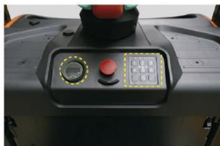
El instrumento de control multifuncional puede mostrar las condiciones del vehículo, la capacidad de la batería, el tiempo de trabajo, la velocidad de desplazamiento y el ángulo de dirección. Al haber un error, la luz del anillo exterior del instrumento cambiará de rojo a verde y se mostrará el código de error.
