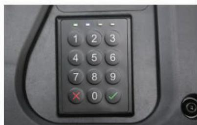
El acceso con PIN se puede configurar con múltiples contraseñas y también permite la activación de tarjetas RFID.
