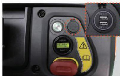
El indicador LCD multifuncional muestra información sobre la batería restante, las horas de funcionamiento y los códigos de error. Con puerto USB integrado para cargar otros dispositivos.
