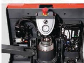
El diseño de las transpaletas y los componentes utilizados están diseñados para facilitar el trabajo y el mantenimiento. Todos los componentes son fáciles de alcanzar al retirar la cubierta principal solo con 2 tornillos, la rueda motriz y las ruedas estabilizadoras son fáciles de sustituir sin necesidad de elevar la transpaleta.
