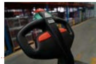
Esta gama de apiladores de este modelo se puede equipar con la opción de **Dirección Asistida Eléctrica (EPS)** que ofrece un control preciso y rápido para la posición del volante y tiene un alto nivel de fiabilidad y seguridad de acuerdo a con las normas oficiales,
