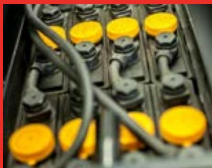
La transpaleta puede ser equipada con la opción de Aquamatic, un sistema de recarga rápida de agua destilada en las baterías de plomoácido. La transpaleta de 2 toneladas puede ser equipada con una batería 3VBS estándar, que ayuda a reducir la longitud de la carretilla original y la hace más compacta. (La batería estándar es de 2PzS)
