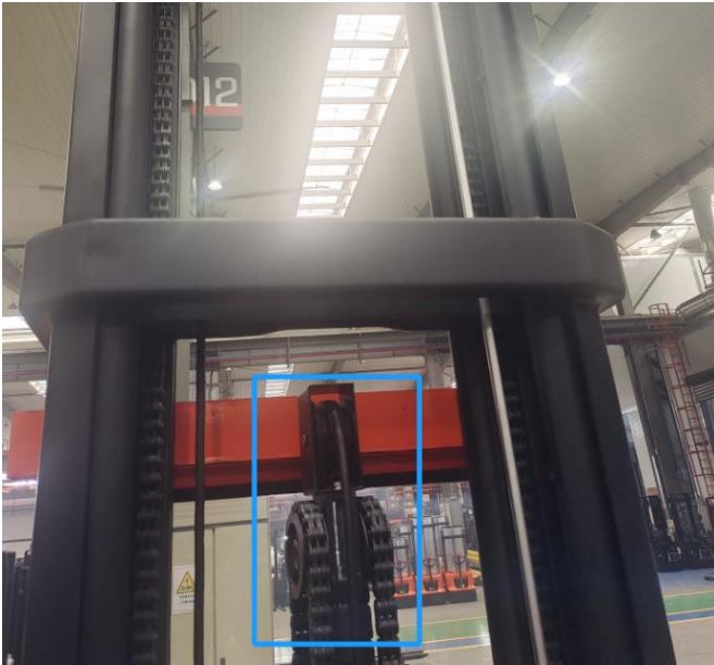
Comprobación del desgaste de la cadena
