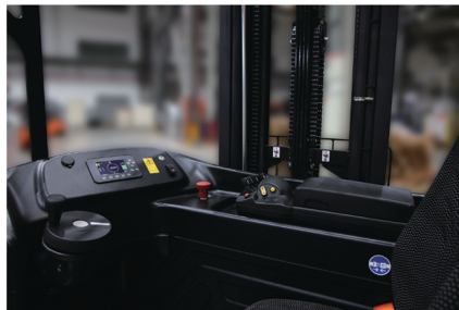
Consola de control ergonómica con manejo mediante mini-palancas (fingertips)
