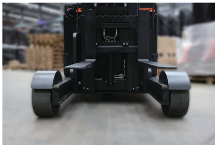
Desplazador de horquillas lateral integrado
