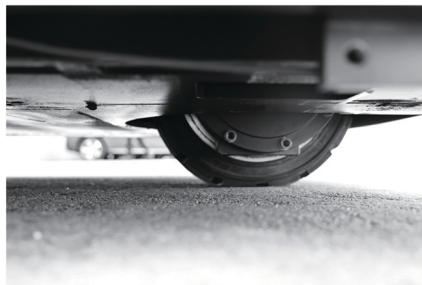
Chasis elevado de 120 mm para una mejor capacidad de paso
