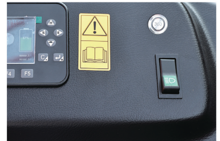
Cambio en tiempo real entre modos de dirección de 180° y 360°
