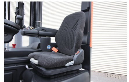
Asiento con suspensión (Grammer) opcional con alta absorción de impactos
