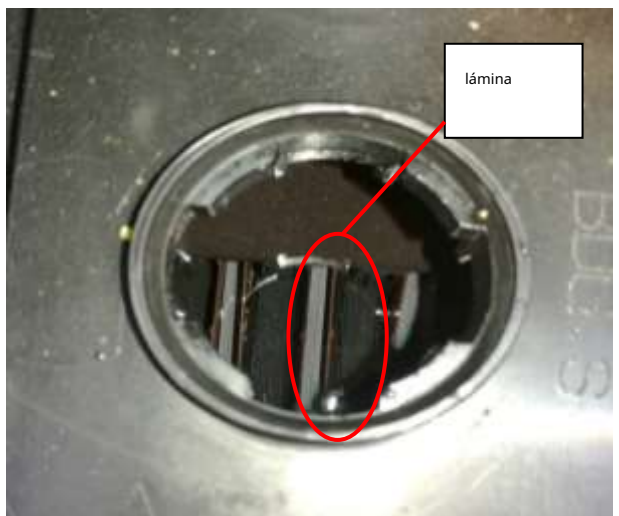
4. No se puede ver la barra colectora en algunos modelos. Cuando el nivel del líquido esté 10 mm más bajo que la placa, agregue agua destilada.
