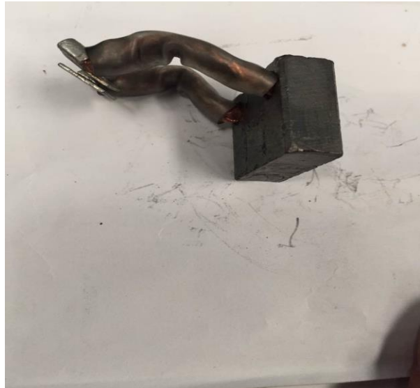
3. Desenrosque el tornillo con un destornillador de estrella y extraiga la escobilla de carbón para reemplazarla. El proceso de instalación es el inverso al anterior.
