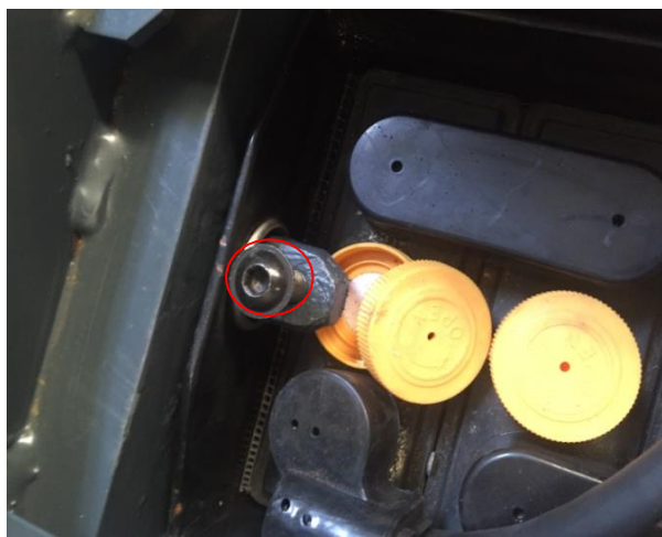
3. Desenrosque los tornillos con una llave hexagonal de 5 mm.
