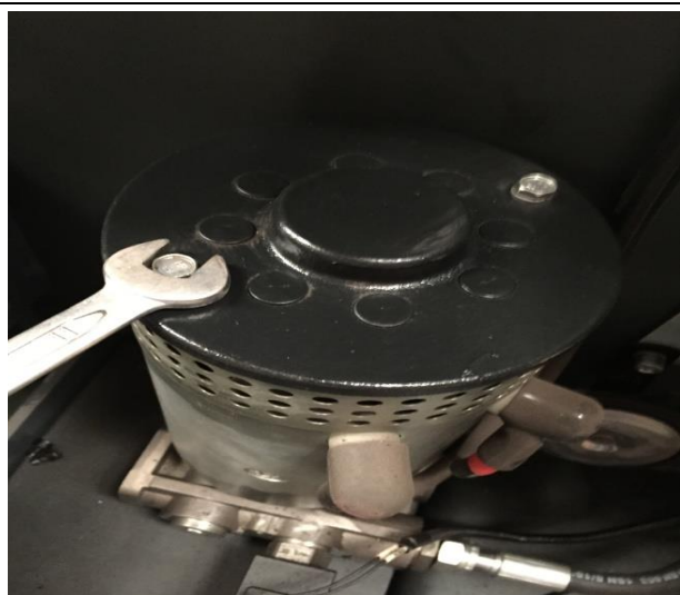
1. Desenrosque los pernos con una llave de boca de 10 mm.
