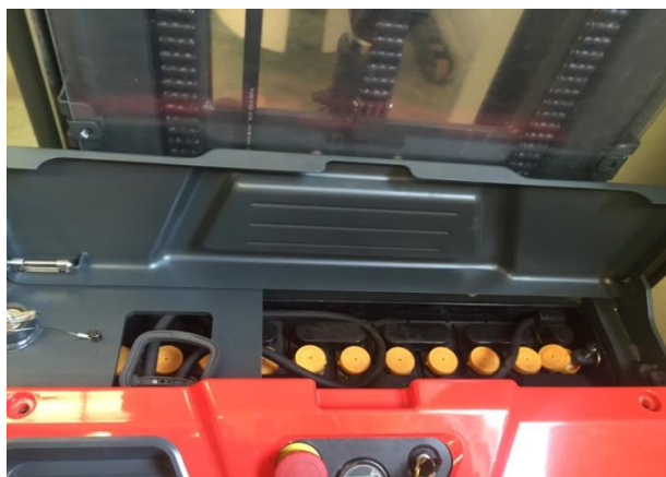
1. Abra la tapa del compartimento de la batería.
