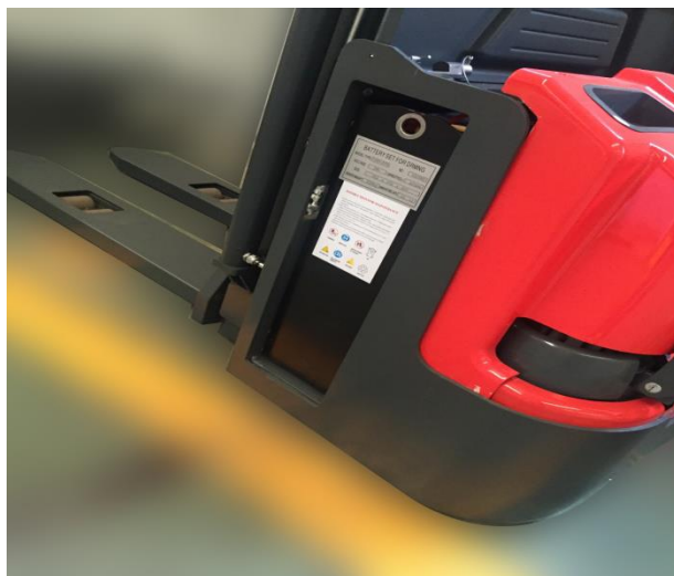
5. Extraiga la batería en la dirección indicada por la flecha y el proceso de instalación es el inverso al proceso de extracción.
