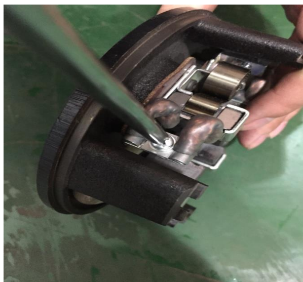
3. Desenrosque el tornillo con un destornillador de estrella y extraiga la escobilla de carbón para reemplazarla. El proceso de instalación es el inverso al anterior.
