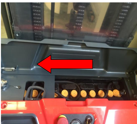
5. Extraiga la batería en la dirección indicada por la flecha y el proceso de instalación es el inverso al proceso de extracción.
