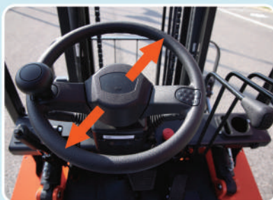
El uso de un volante de menor diámetro reduce la fatiga del operador.
