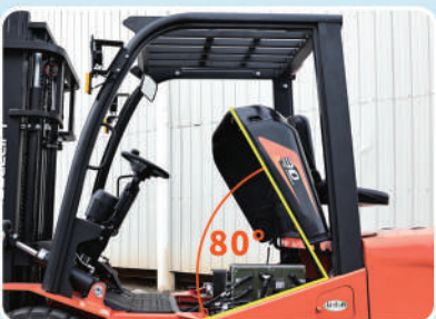
El capó del motor se abre a un ángulo de 80 grados.
