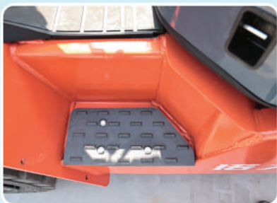
Escalón de acceso ampliado.
