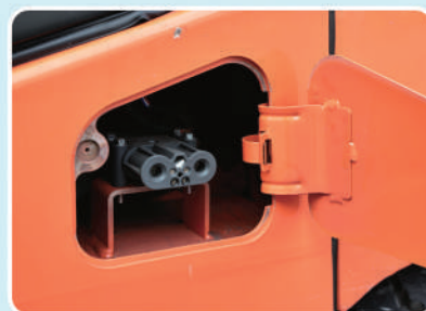
Puerto de carga de batería de litio.
