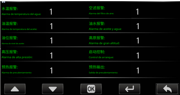
Figura 3.3 Ajustes del estado de la alarma
